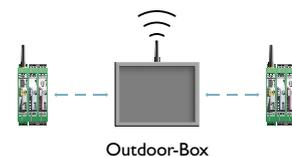
Mesh-Netzwerk mit einer Outdoor-Box als einfacher Repeater
